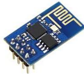
Ilustración 8 módulo Wi-fi que envía información a Smartphone
