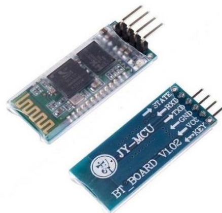
Ilustración 7 Módulo Bluetooth que permite la comunicación Bastón-miniauricular.
